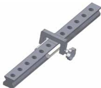
Per il montaggio delle guide in più spezzoni (in mancanza di battuta laterale) allineare le giunzioni delle guide con l'ausilio di alberi rettificati e morsetto come mostrato in figura.
