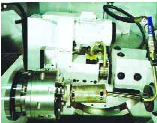
Fase di rettifica interna chioccia/ Internal grinding of the nut
