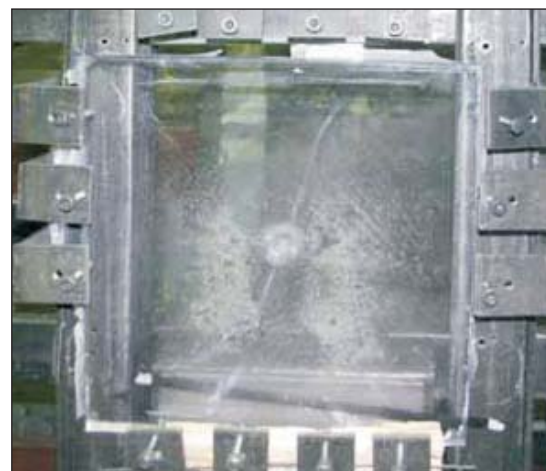
Policarbonato fissato al telaio, dopo la prova di impatto.
