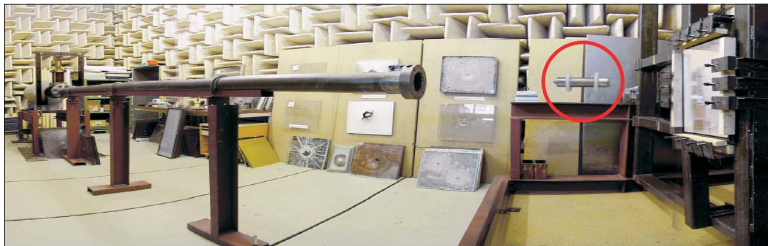
Foto del laboratorio prove all IWF di Berlino. In primo piano sono visibili il cannone e, nel cerchio, il proiettile.
