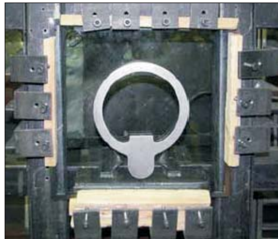
Fissaggio del policarbonato con la piastra degli oblò rotanti VISIPOINT®
