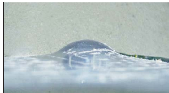
Deformazione del policarbonato dopo l'impatto.
