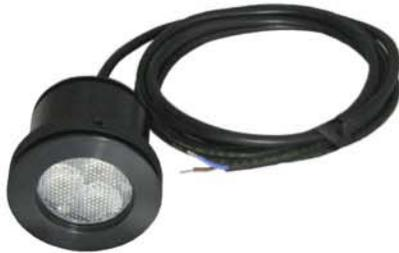
Sistema di illuminazione da pannello a tecnologia LED. Corpo in alluminio anodizzato con 3 power LED; lenti da 8°-25°-40°. Ghiera filettata per il fissaggio. Alimentatore esterno separato. Corrente operativa: 350-500-700mA (! utilizzare solo alimentatori elettronici stabilizzati in corrente continua).
